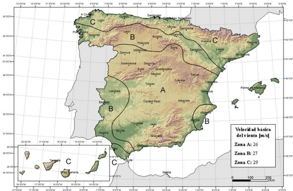
Figura 7.16: Valor del viento básico, en función de la posición geográfica (Fuente: DBSE-AE, Julio 2018).
