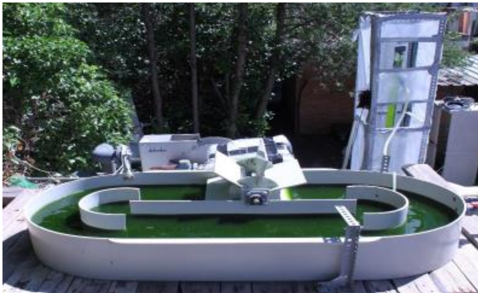
Figura 1.7 Fotobiorreactor abierto (HRAP) situado en el Departamento de Ingeniería Química y Tecnologías de Medio Ambiente
