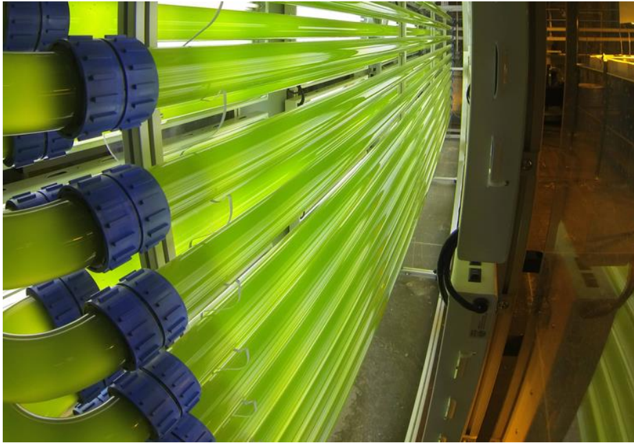
Figura 1.8 Fotobiorreactor cerrado de tipo tubular con iluminación artificial
