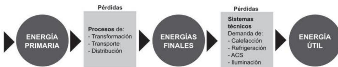
Imagen 4.1. Transformación energía. Fuente: CTE DB-HEO
