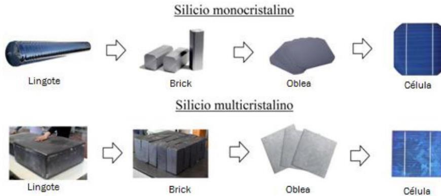
Figura 9.- Proceso de fabricación de una célula a partir de silicio monocristalino y multicristalino.
