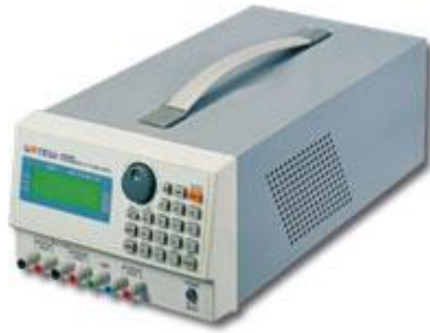
Figura 18.- Fuente de alimentación programable externa utilizada para el funcionamiento de circuitos integrados y en los barridos de voltaje en las medidas I-V.
