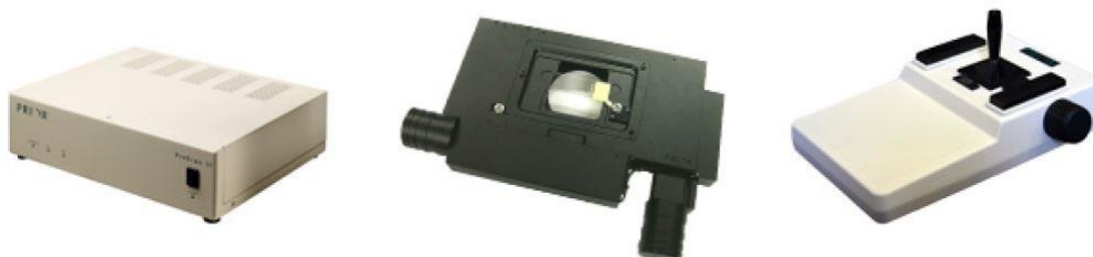
Figura 16.- Controlador ProScan II de la mesa (izquierda), mesa motorizada H101 (centro) y joystick (derecha) que componen el sistema de posicionamiento.
