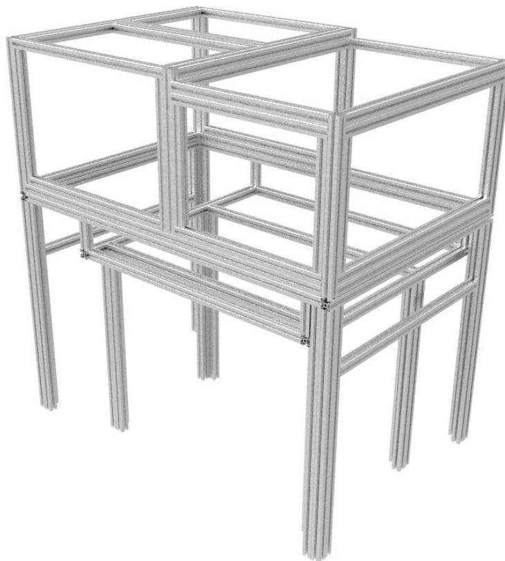
Figura 46.- Conjunto de la estructura formada por perfiles ranurados.
