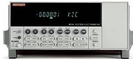
Figura 15.- Electrómetro Keithley modelo 6514 utilizado para la medida de fotocorriente generada en los materiales fotosensibles en estudio.
