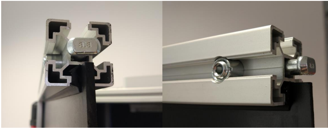
Figura 69.- Panel y perfil unidos junto con la pieza de goma.
