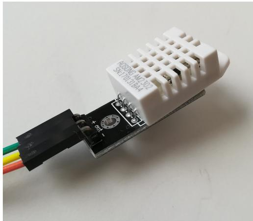
FIGURA 4.2.1. Adaptador del sensor DHT22
