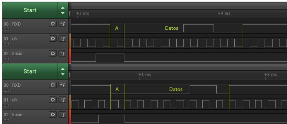
FIGURA 5.2.5. Señales enviadas hacia el módulo de Bluetooth de un sistema dirigido por tiempo
