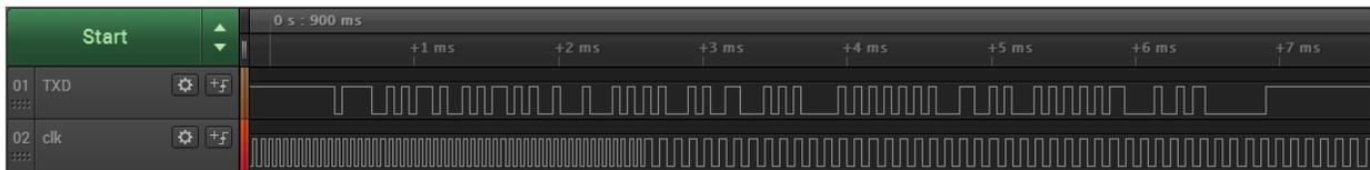
FIGURA 7.4.3. Cambio en la velocidad de transmisión
