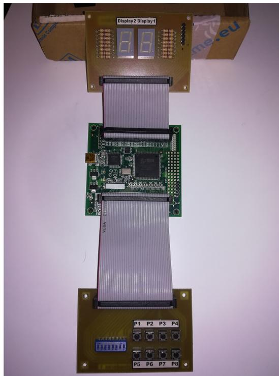
FIGURA 1.4. Placa MachXO2 Breakout Board con las PCBs incorporadas
