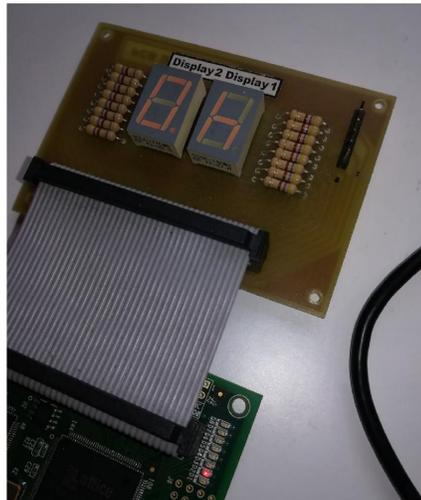
Los leds muestran "010", es decir, una frecuencia del puerto serie de 9.6kHz, mientras que si fuera "001" sería de 19.2kHz, y si fuera "100" sería de 4.8kHz.
