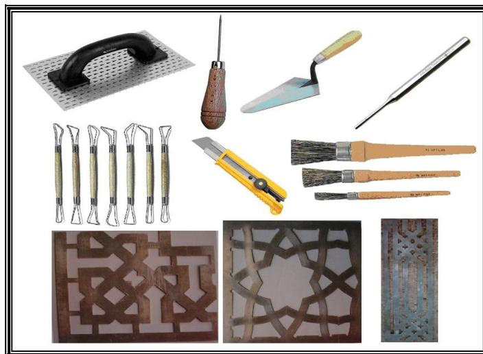
Fig. 2: Herramientas que se utilizan para elaborar el esgrafiado.
