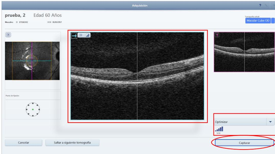
Figura 10.- Pantalla de captura de imagen, centrado, optimización y captura (OCT Primus 200, Zeiss)
