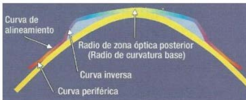
Figura 2. Lente de doble geometría inversa. Imagen sacada de la Guía de Ortoqueratología Nocturna de Bausch&lomb Company.
