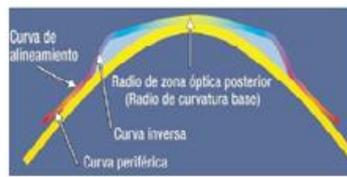
Figura 4. Perfil de una lente de geometría inversa doble. Bausch & Lomb Company. <sup>6</sup>
