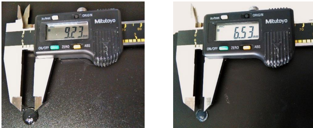
Fig. 7.8. Medida de hidrogeles a distinta temperatura. La de la izquierda representa un hidrogel a 4°C y la de la derecha un mismo hidrogel a 37°C.
