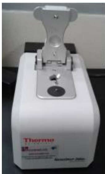
Fig. 6.5. Espectrofotómetro de microvolumen UV-Vis NanoDrop 2000c
