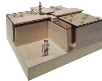
Fig.65. Planta de distribución. Pieles utilizadas en la construcción. Maqueta escuela campo de refugiados, Jordania.
