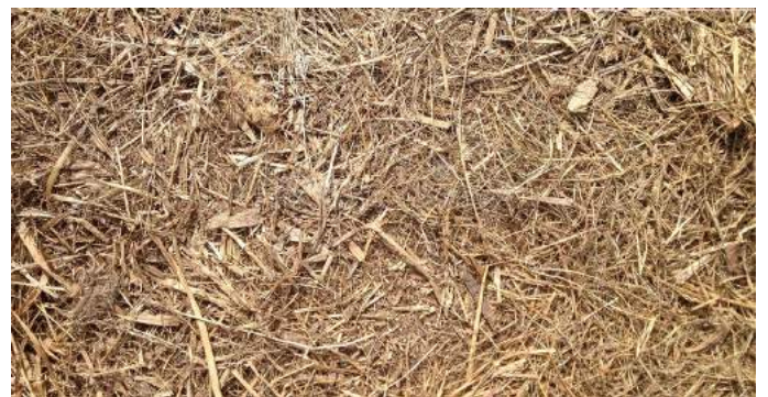
Fig. 30 : Textura de paja como material estabilizante
