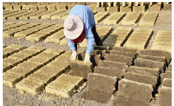
Fig. 48 : Proceso de secado de los bloques
