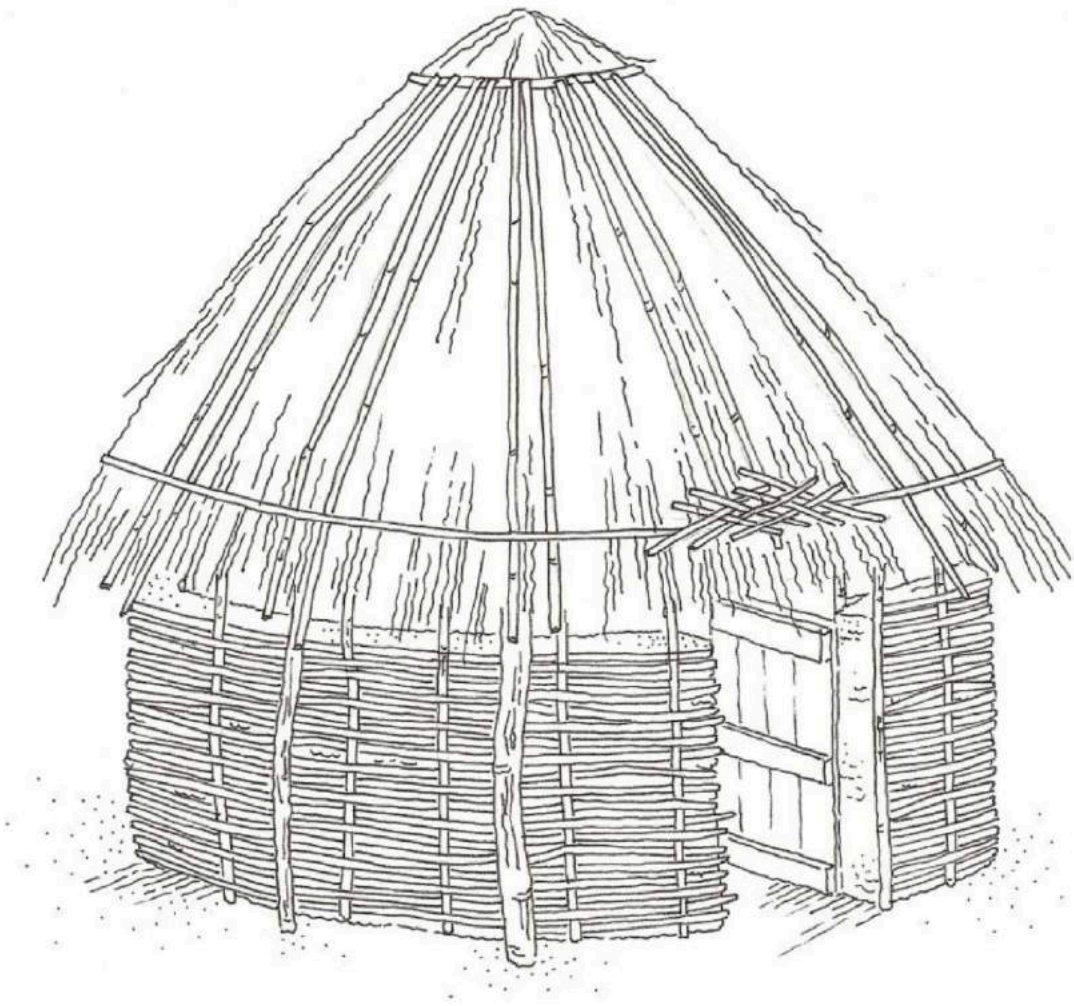
Fig 121 : Dibujo de construcción circular ejecutada con muro mixto
