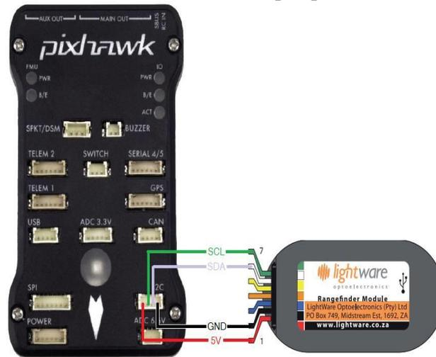
Figura 5.20 Conexión LiDAR[20]
