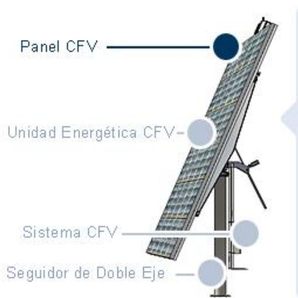
**Figura 2.13.** Partes de un panel de concentración.
