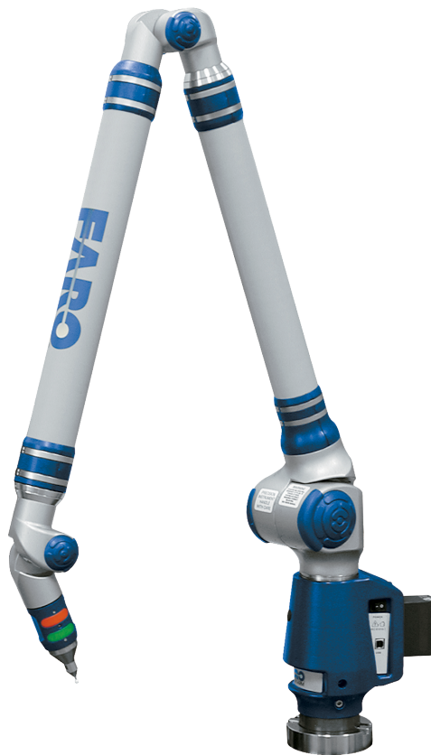
Figura 11.1: Brazo de medición portátil FaroArm Platinum. Fuente: Faro (2009).
