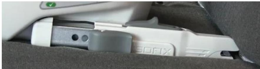
Figura 16. Detalle relativo al mecanismo de anclaje del SRI BeCool Nado O3 [12]
