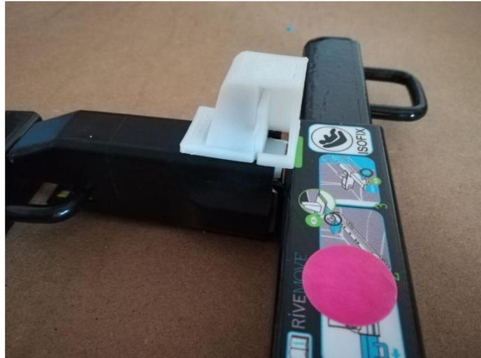
Figura 51. Prototipo bloqueado de la versión de tirador en forma de L instalado en la tecnología RMLG3
