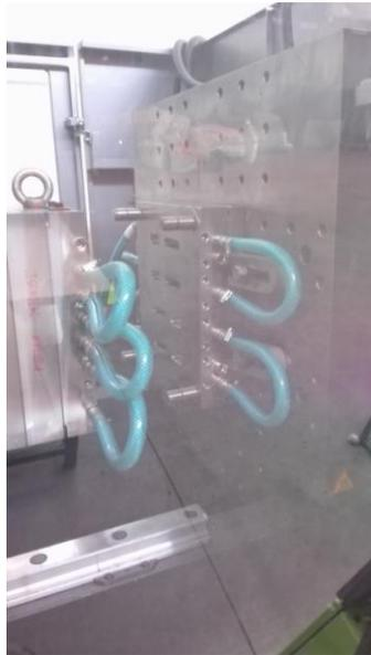
Figura 93. Sistema de refrigeración incluido en el molde de inyección
