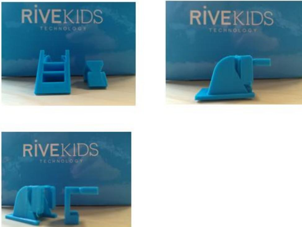
Figura 63. Prototipos del mecanismo con tirador en forma de cola de milano
