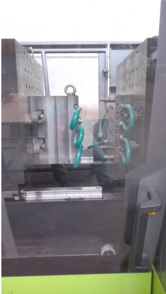
Figura 94. Plato móvil y plato fijo de una máquina de inyección
