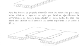
Para los huecos de gran dimensión como los necesarios para pasos de escaleras o garajes se opta por aberturas completas, ejecutándose mediante la colocación de una perfil de acero que sustente la losa que haya sido necesario cortar en todo su ancho.
