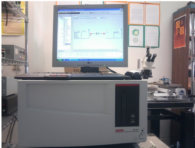
Figura 2.1: Analizador de semiconductores Keitley 4200-SCS
