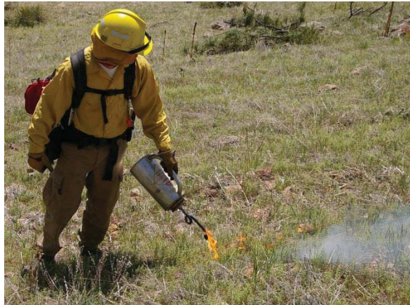
Figuras 32 y 33: Antorcha de goteo. Técnico haciendo uso de la antorcha de goteo para la realización de una quema controlada. Fuente: Informe final de actividades de la cuadrilla de precampaña. Comarca de las Merindades (2014).
