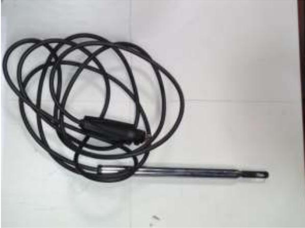
Figura 33. Sonda de medición de velocidad.
