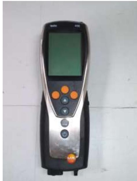
Figura 34. Medidor multifunción Testo 435
