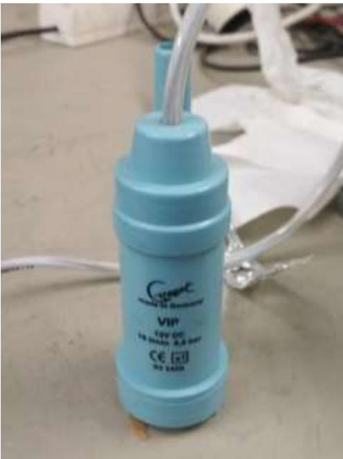
Figura 39. Bomba de recirculación del agua.
