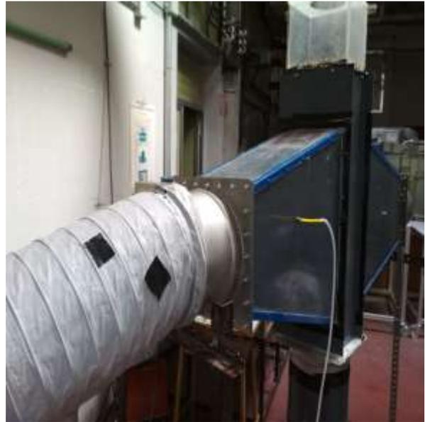
Figura 32. Detalle de la conexión del tubo flexible-plenum
