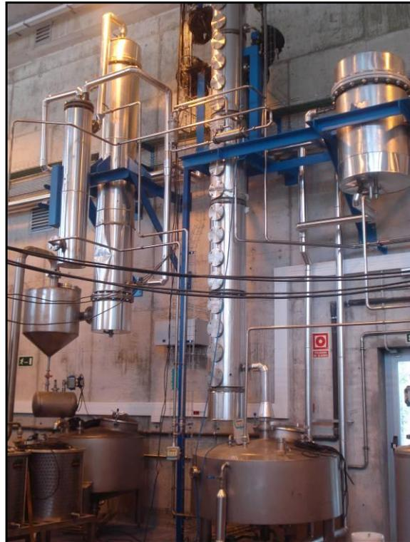
Foto12:Columna de destilación y evaporadores,
