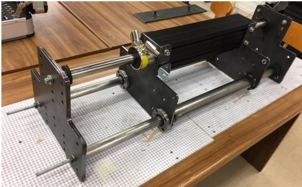
*Figura 3.60: Apriete de las varillas roscadas en la base superior y fijación del vástago en ambas bases del excitador inercial.*
