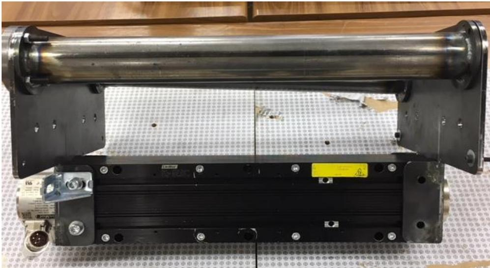
Figura 3.47: Posicionamiento sin fijación a la brida del motor lineal de la culata inferior.
