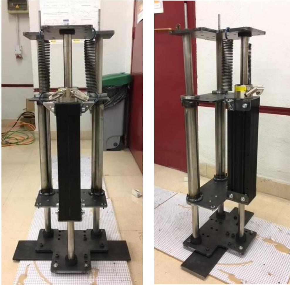
*Figura 3.63: Montaje completo del excitador inercial en posición vertical (derecha e izquierda).*
