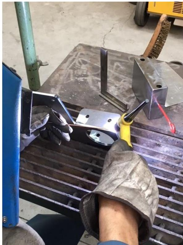
Figura 3.19: Soldadura de la segunda brida por la parte externa. Primer cordón de soldadura.
