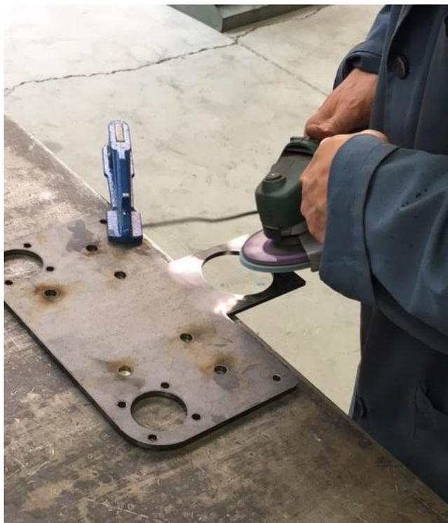
Figura 3.7: Limpieza de las cuatro zonas de las placas intermedias donde se efectuará la soldadura TIG.
