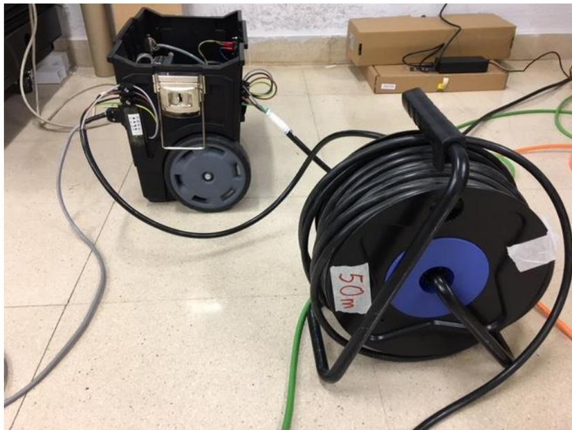
*Figura A6.20: Vista general de la conexión intermedia del maletín de control y el tambor de cable.*
