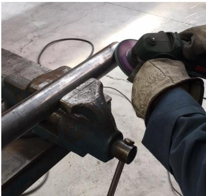
*Figura 3.23: Limpieza de los tubos de 50mm en ambos extremos, mediante radial.*
