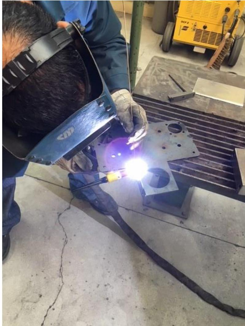
*Figura 3.10: Realización del segundo punto de soldadura de la segunda brida, al otro extremo del borde de la placa intermedia.*
