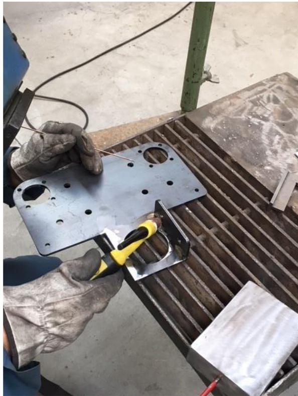
Figura 3.11: Soldadura de la primera brida por la parte interna. Primer cordón de soldadura.
