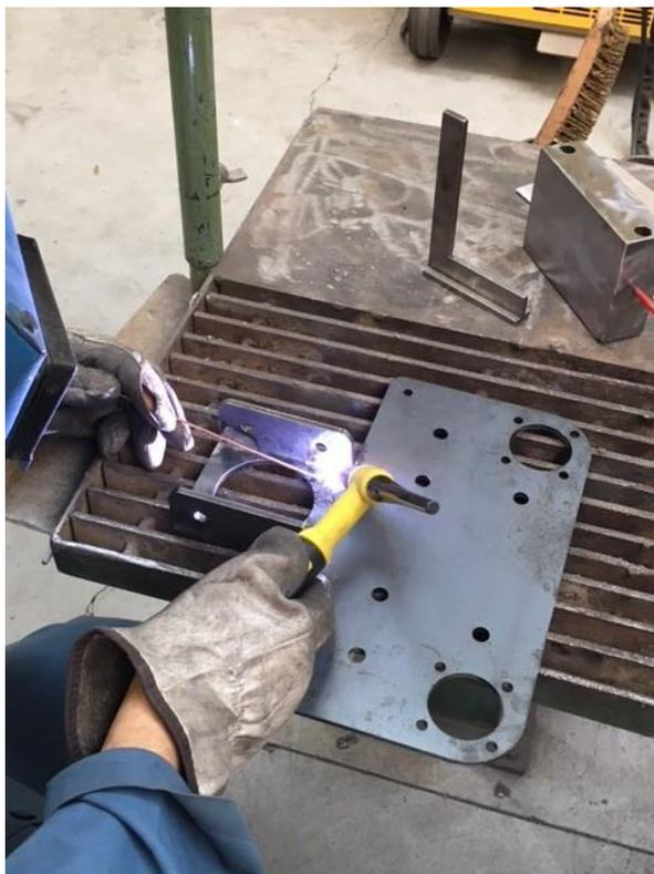
*Figura 3.17: Soldadura de la segunda brida por la parte interior. Primer cordón de soldadura.*
