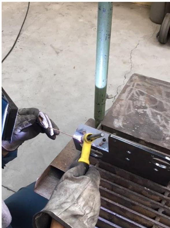
*Figura 3.13: Soldadura de la primera brida por la parte externa. Primer cordón de soldadura.*
