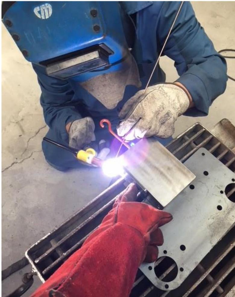
*Figura 3.9: Realización del primer punto de soldadura de la primera brida al borde de la placa intermedia.*
