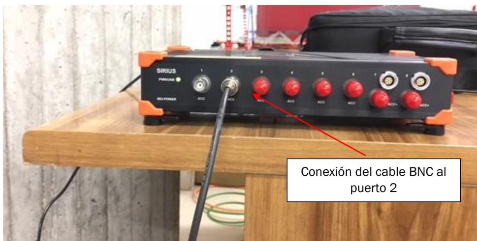
Figura A6.11: Conexión del cable BNC al puerto número 2 del Sirius.
