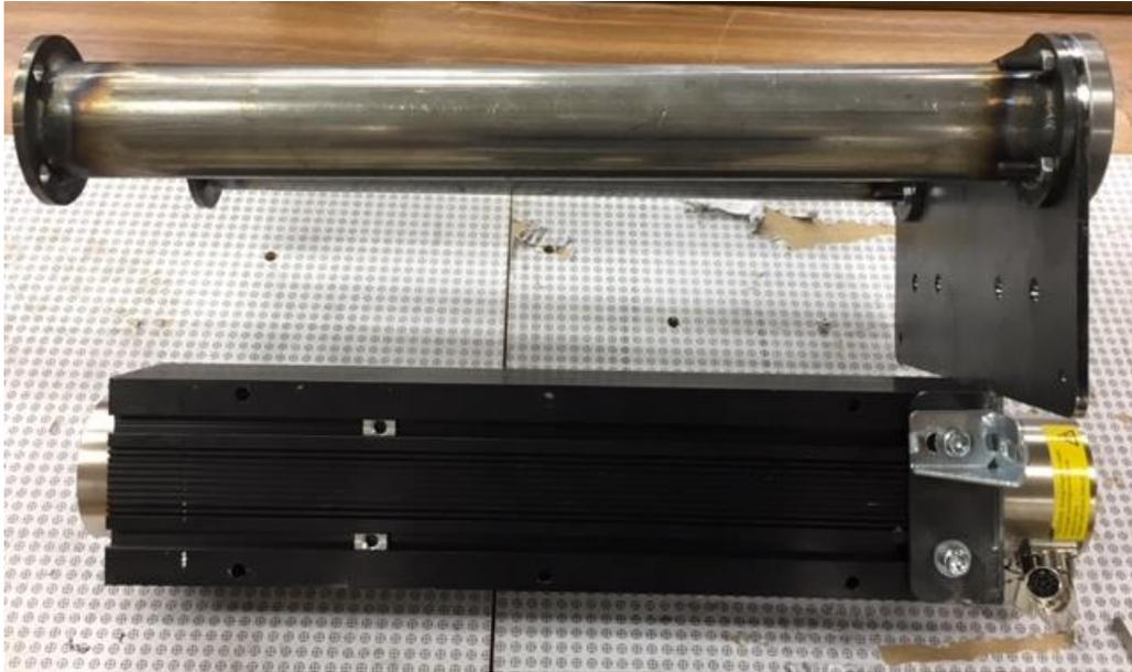
Figura 3.45: Anclaje del segundo soporte intermedio de los rodamientos lineales de bolas.
