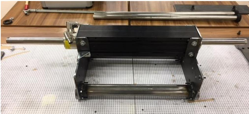
*Figura 3.54: Introducción del vástago en el estator.*
