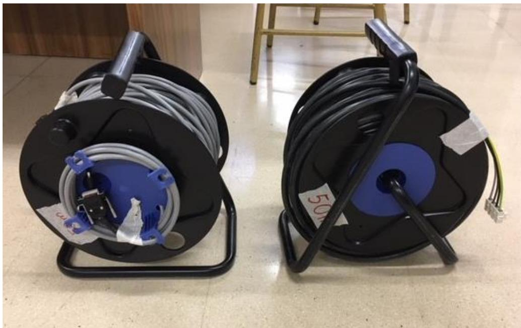
Figura A6.13: Tambores de cables de 50 metros de longitud.
