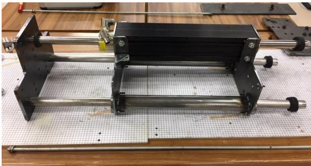
*Figura 3.57: Posicionamiento de la base superior del excitador inercial en el vástago y los tubos de acero inoxidable.*
