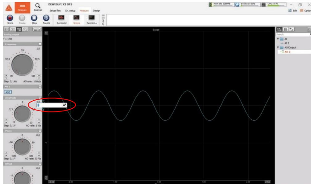
Figura A5.18: Modificación de la amplitud a 2V.
