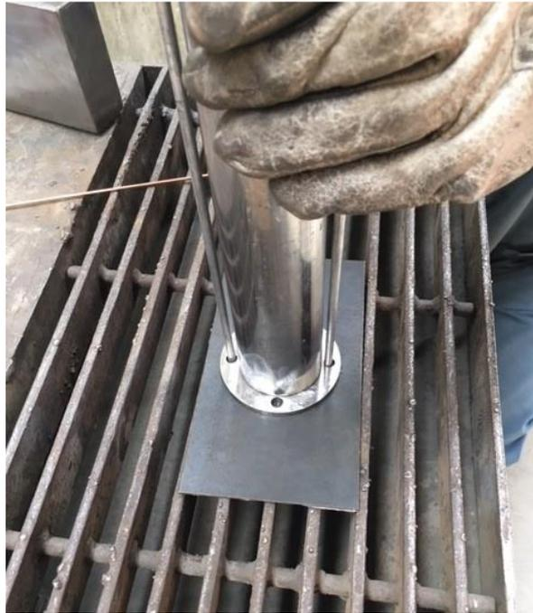
*Figura 3.32: Posicionamiento de la brida, al otro extremo del tubo de acero de 50mm.*
