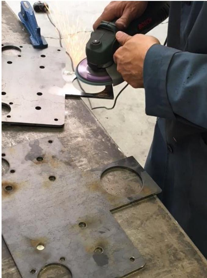
*Figura 3.6: Limpieza de las zonas dónde se desarrollará el cordón de soldadura en las placas intermedias.*
