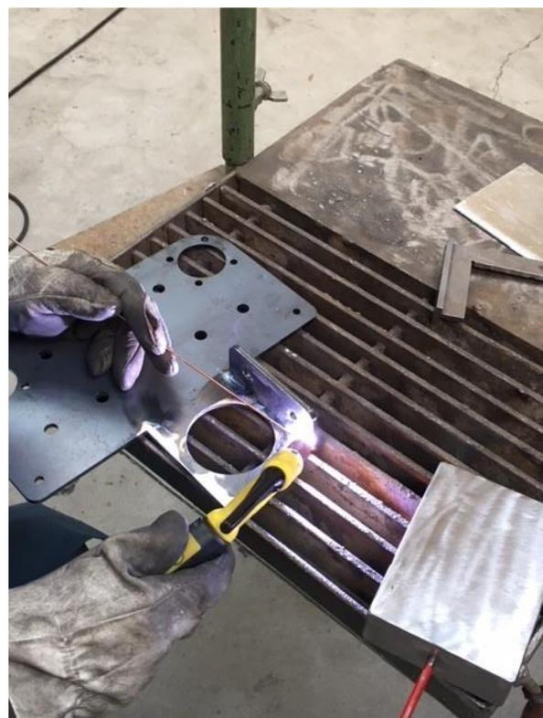
Figura 3.12: Soldadura de la primera brida por la parte interior. Segundo cordón de soldadura.
