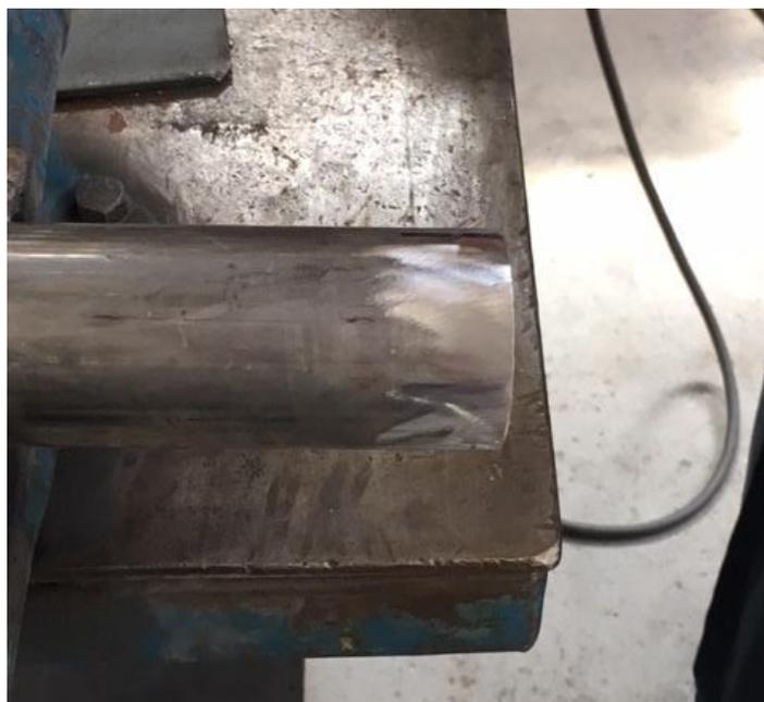
*Figura 3.24: Resultado de la limpieza de un extremo del tubo de 50mm.*
