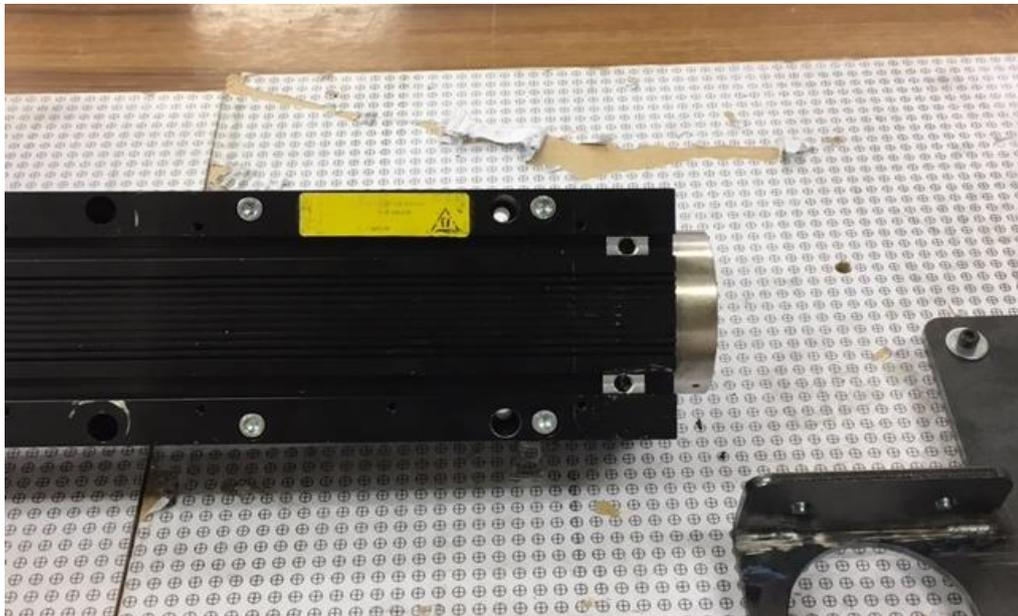
Figura 3.46: Introducción de las cuatro tuercas rectangulares en las canalizaciones de la brida.
