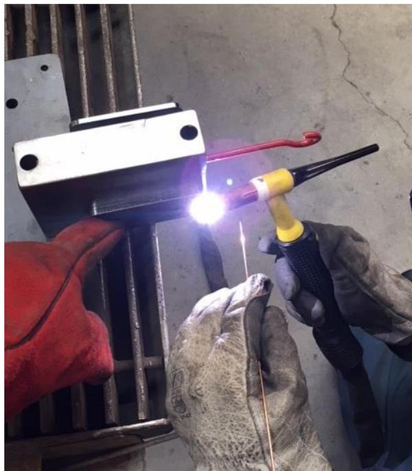
*Figura 3.15: Ejecución del primer punto de soldadura de la segunda brida al borde de la placa intermedia.*
