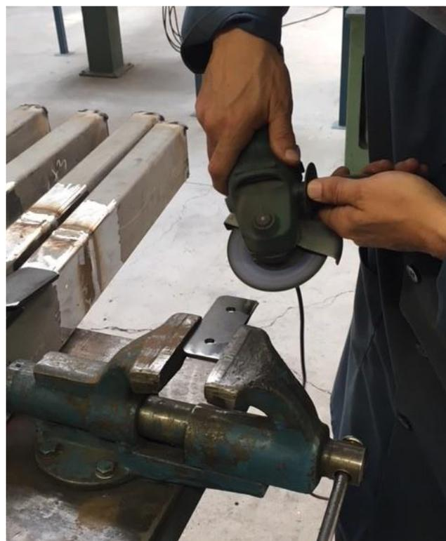
Figura 3.8: Limpieza de las dos zonas a ambos lados de la brida donde se realizará la soldadura TIG.
