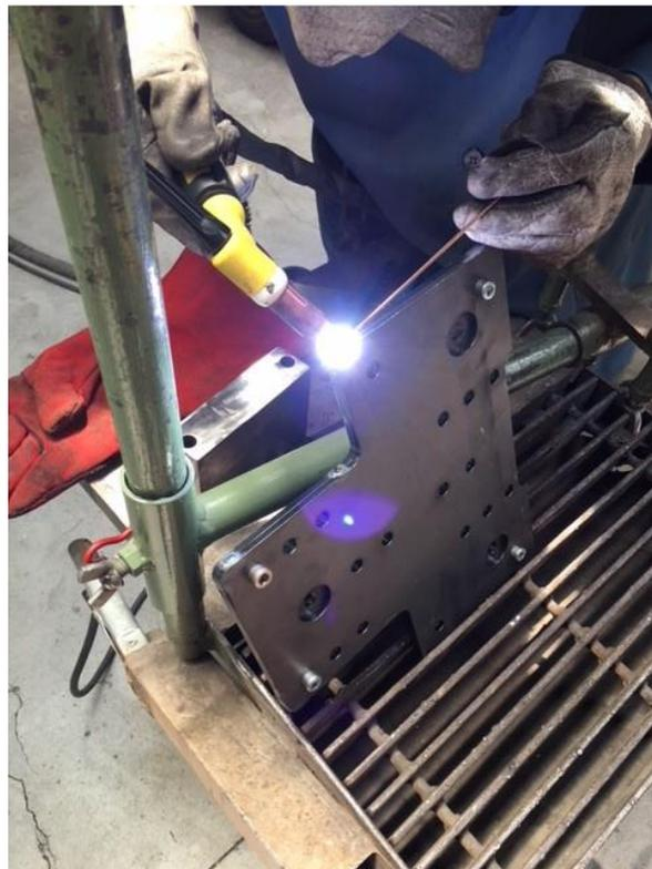
*Figura 3.2: Soldadura de las bases, externa e interna, en las caras laterales por medio de soldadura TIG.*
