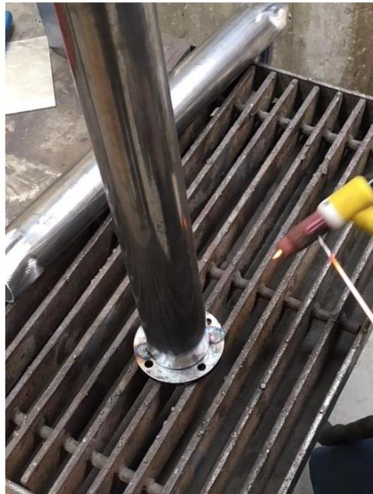
*Figura 3.28: Ejecución del segundo punto de soldadura en un extremo del tubo, entre el tubo y la brida.*
