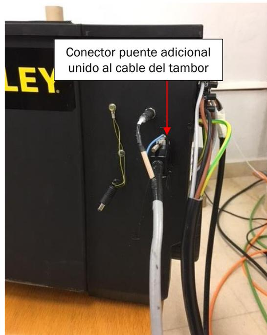
*Figura A6.15: Conexión de un extremo del cable del tambor al maletín de control.*
