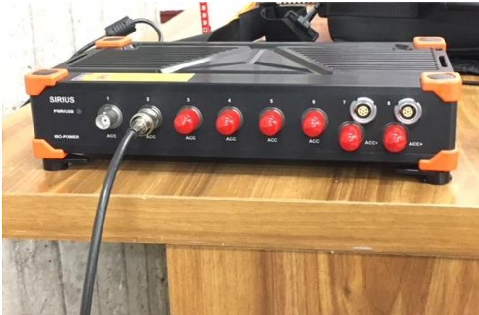
Figura A5.3: Conexión del cable BNC en el puerto de salida 2 del Sirius.
