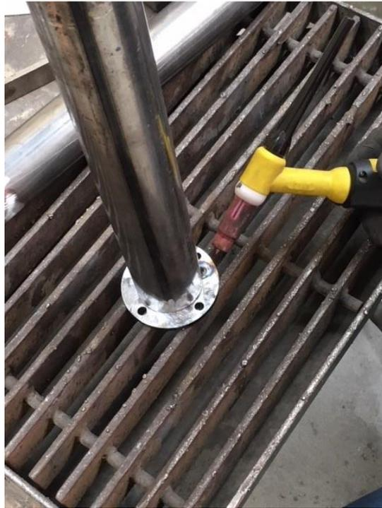
*Figura 3.27: Ejecución del primer punto de soldadura en un extremo del tubo, entre el tubo y la brida.*
