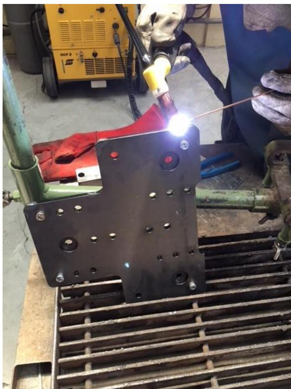
*Figura 3.3: Soldadura TIG en las caras laterales de las bases, exterior e interior, con varilla de aportación.*
