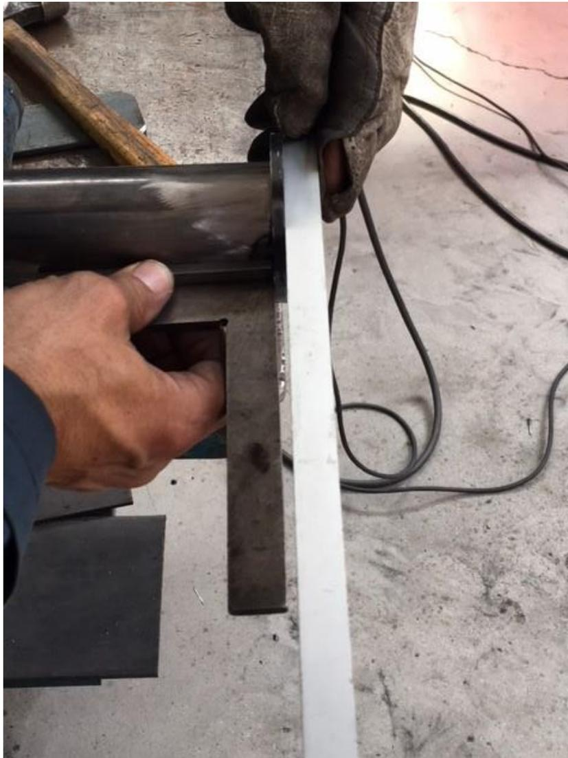
*Figura 3.30: Comprobación de la perpendicularidad del tubo de acero inoxidable con la brida.*
