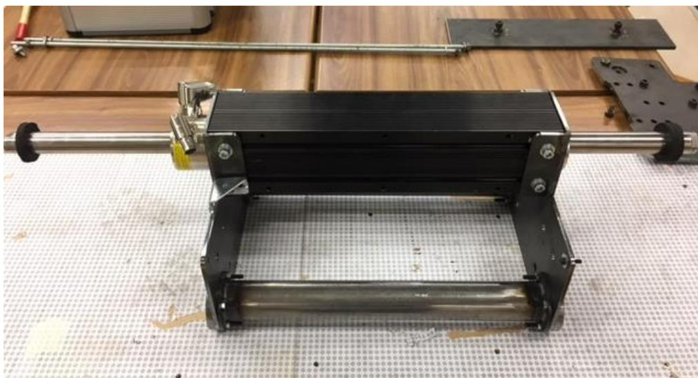
*Figura 3.55: Inserción de arandelas de caucho a ambos lados del vástago.*
