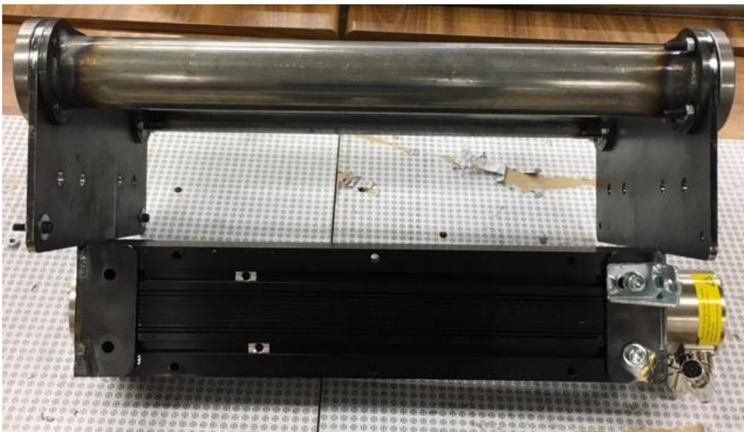
*Figura 3.51: Introducción del segundo rodamiento lineal en la parte inferior del conjunto móvil.*
