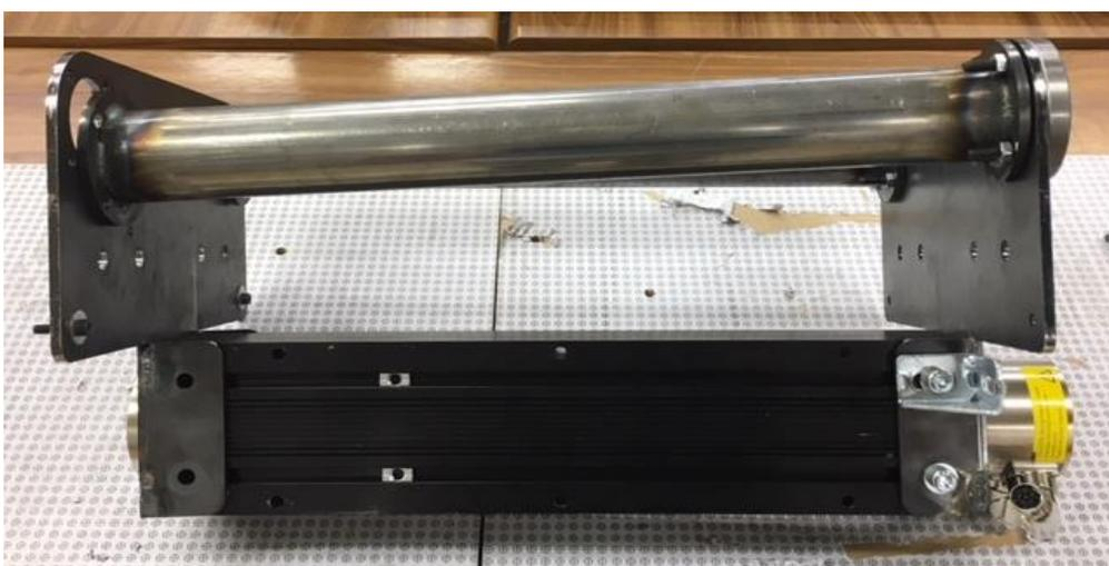
Figura 3.48: Desalineamiento de uno de los soportes intermedios.
