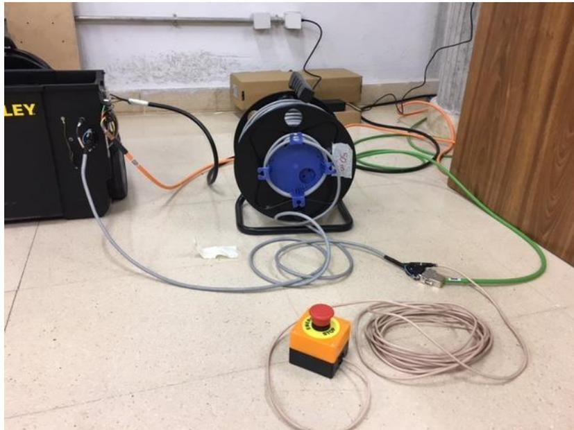
*Figura A6.14: Conexión de larga distancia del cable de sensor de posición del motor lineal.*
