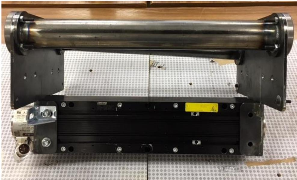
Figura 3.50: Fijación a ambos lados del primer soporte intermedio de rodamientos lineales.
