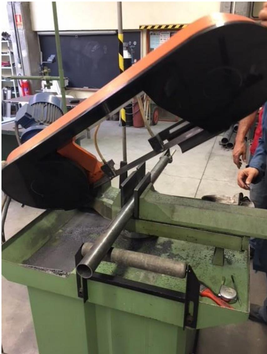
Figura 3.22: Corte de los tubos de 50mm de diámetro.
