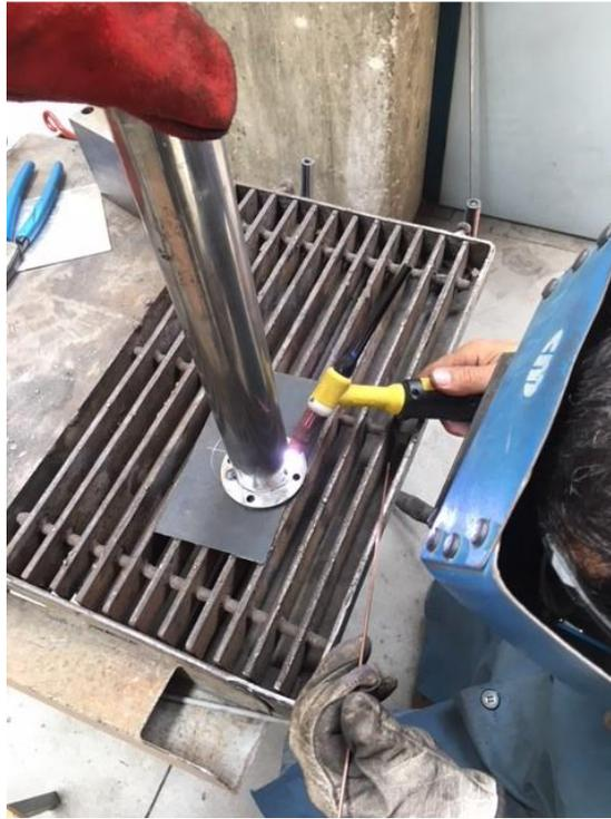
*Figura 3.34: Ejecución del segundo punto de soldadura en la unión del tubo de acero con la brida.*
