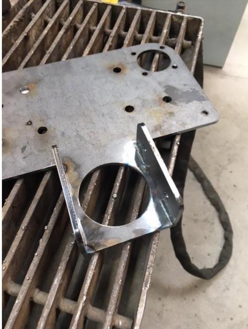
*Figura 3.21: Finalización del proceso de fabricación de la culata.*
