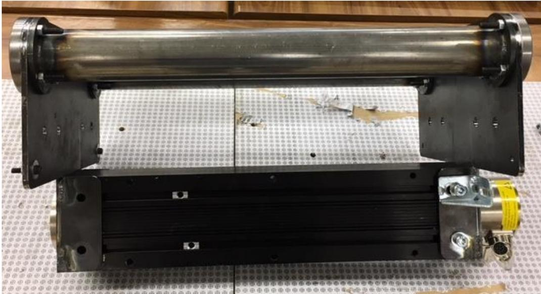
*Figura 3.52: Fijación a ambos lados del segundo soporte intermedio de rodamientos lineales.*
