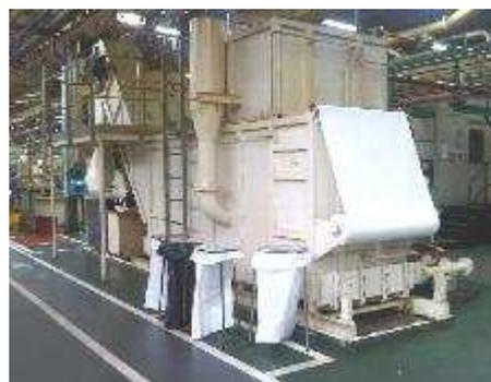
El papel es la parte consumible del medio filtrante (se va renovando cada ciclo de filtración). Además, define el grado de filtración o tamaño de partícula ya que es la parte que va a estar en contacto con el líquido de corte. Los principales parámetros del papel son: gramaje, material de fabricación, espesor, luz de malla, etc.
