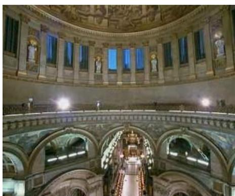
¿Qué es lo que sucede en esta sala? De forma intuitiva, podemos ver que si tenemos una sala con forma circular como la de la figura y emitimos un sonido cerca de la pared, dicho sonido se propagará por el perímetro de la misma, y será perfectamente audible en el extremo diametralmente opuesto de la sala pero no en el centro de la misma. En la imagen se muestra cómo se propaga el sonido desde la fuente sonora A hasta el receptor B, y la línea de puntos indica la zona
