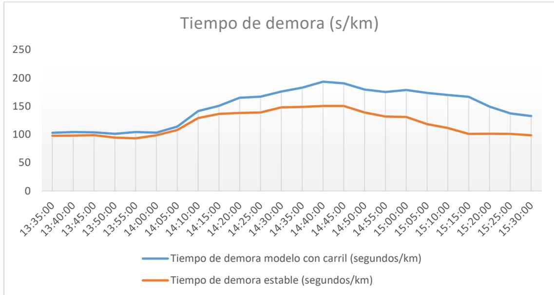
**Figura 3.46.** Comparación tiempo de demora (s/km) de los coches.
