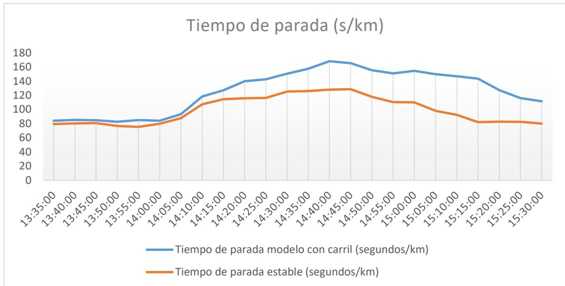
**Figura 3.49.** Comparación tiempo de parada (s/km) de los coches.
