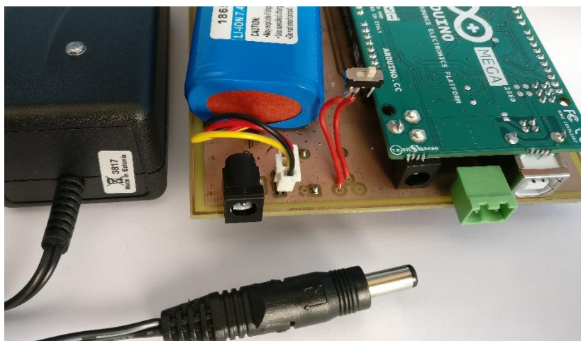
Figura 30. Imagen de la PCB. Detalle de los conectores del circuito de alimentación, la batería, el interruptor y el cargador
