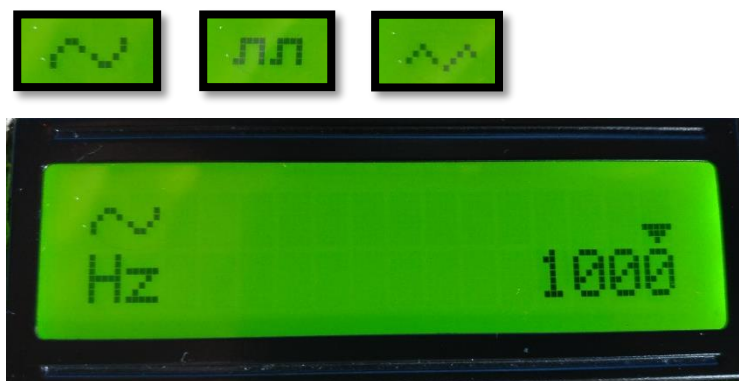
Pantalla de función F4, detalles de los símbolos de onda senoidal (izquierda), cuadrada (centro), triangular (derecha)
