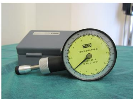
Imagen 2: algómetro de presión con punta de goma y transductor de fuerza. Imagen del algómetro utilizado en el estudio.
