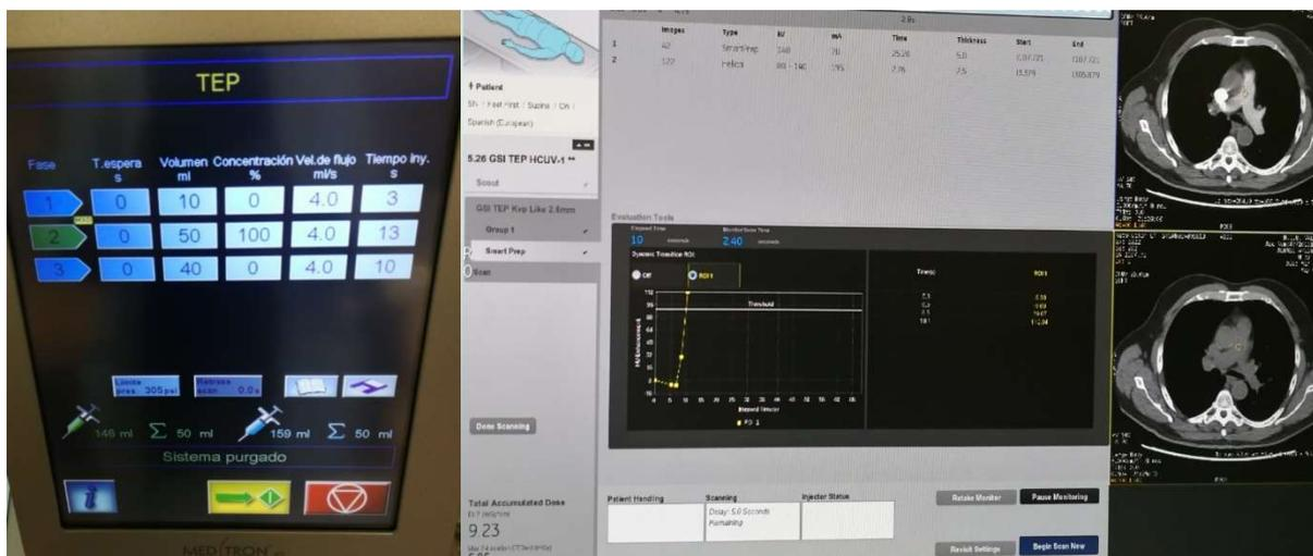
Figura 8. Técnica de inyección del contraste. Imagen derecha: pantalla del inyector con el protocolo establecido; imagen izquierda: pantalla durante la inyección del contraste mediante la técnica “bolus tracking”.
