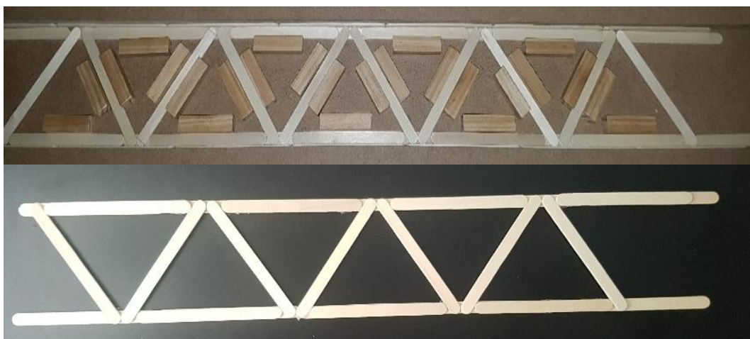
Figura 25: Montaje de celosía de prueba.
