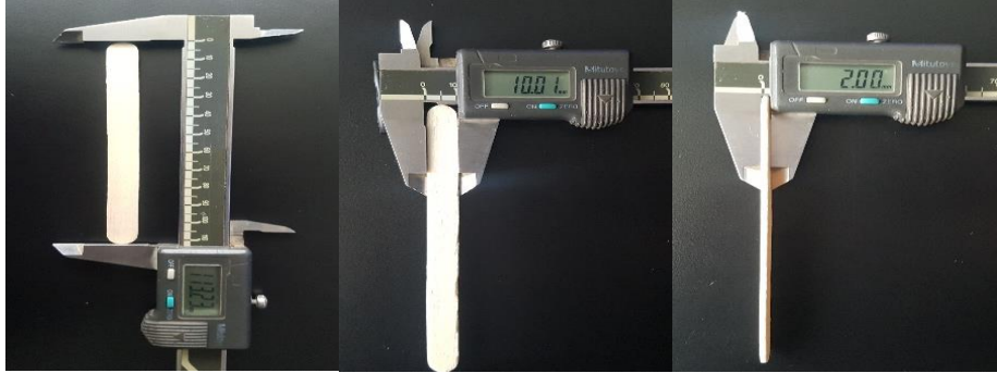
Figura 22: Caracterización de la geometría de los palitos con un pie de rey.
