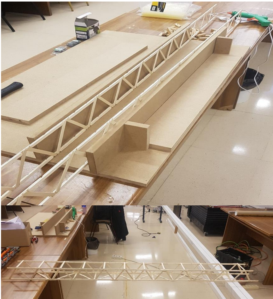
Figura 30: Montaje de la estructura con los soportes.
