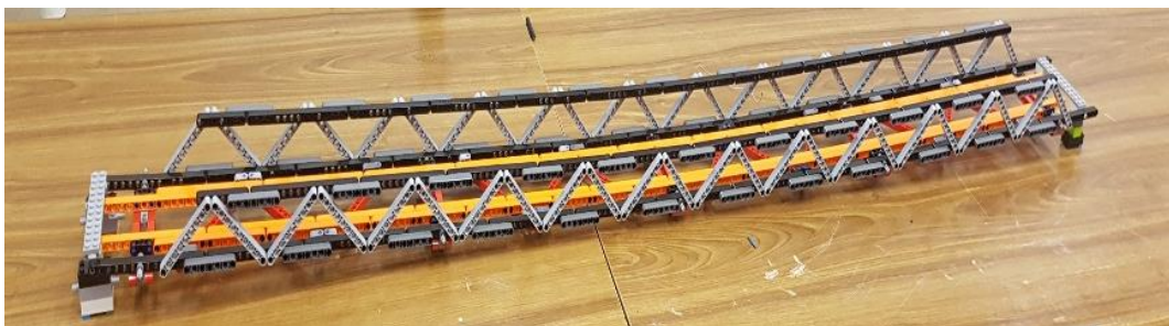
Figura 18: Maqueta de viaducto con tipología Warren realizada con Leggo.
