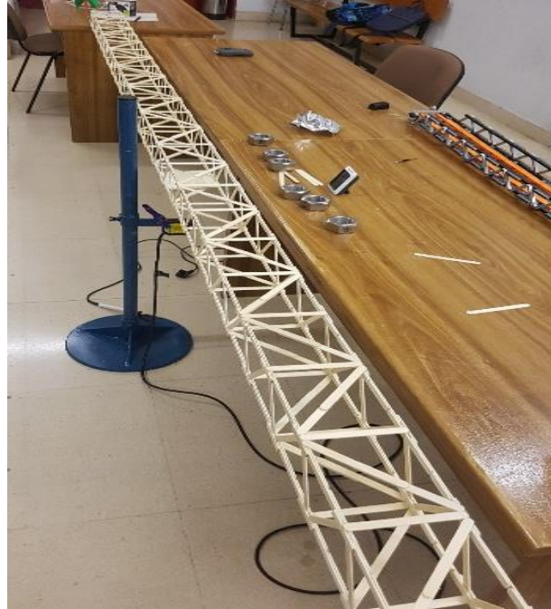
Figura 41: Láser ubicado en la sección media del puente
