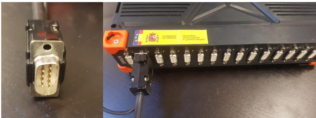
Figura 13: Conector macho láser conectado a SIRIUS HD-STG.
