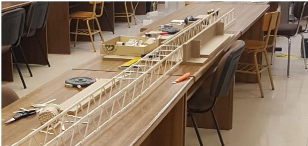
Figura 34: Montaje de las uniones perpendiculares de los nudos de las celosías.
