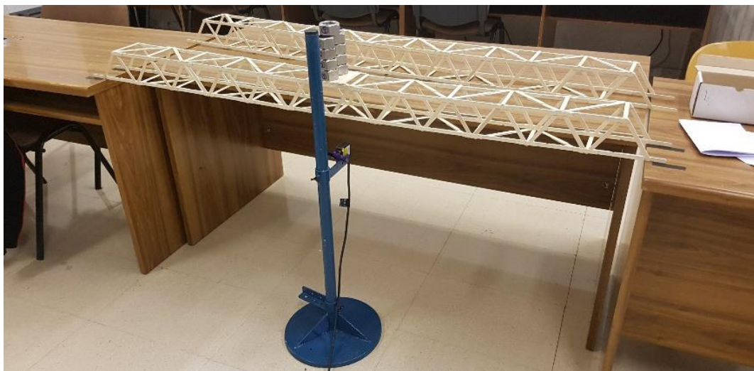
Figura 32: Puentes mellizos sometidos a carga de 9 tuercas.
