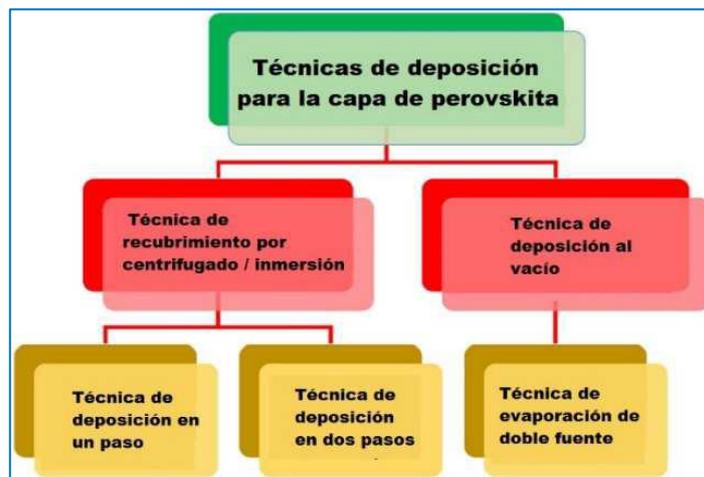
Figura 27. Técnicas de deposición de perovskita sobre las células fotovoltaicas.
