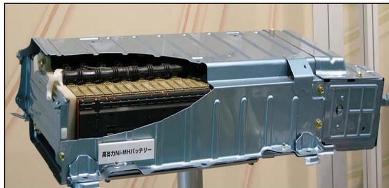
Figura 15: Batería Ni-MH
