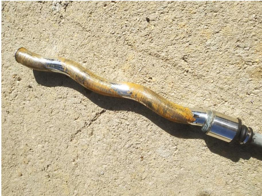
*Ilustración 17: Rotor de la bomba erosionado a causa del plástico.*
