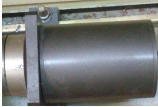
Figura 5: Tacómetro (15V x 1000rpm)
