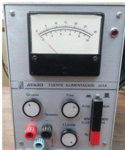
Figura 44: Fuente de alimentación para el circuito de excitación de la máquina síncrona
