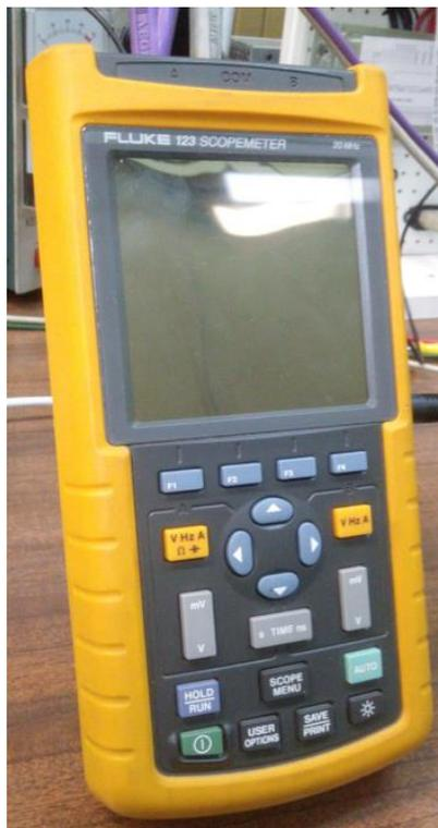
Figura 2: Osciloscopio
