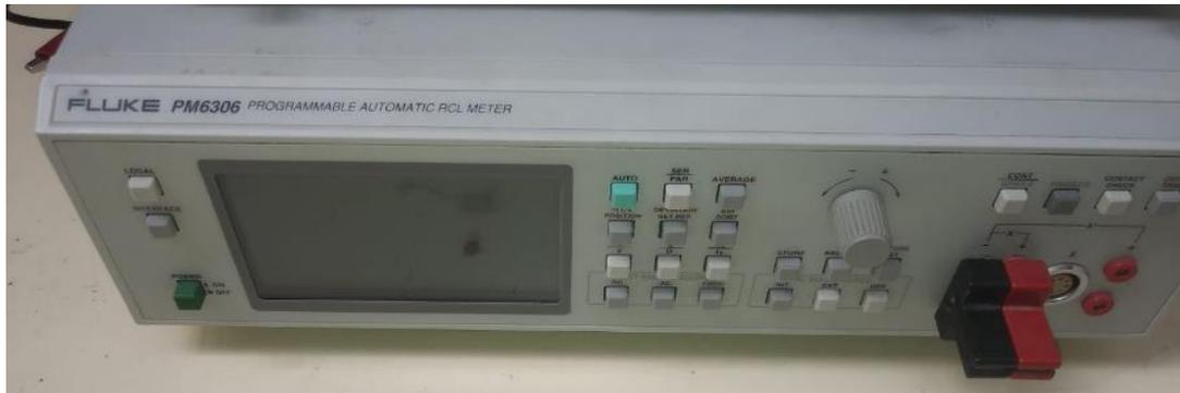
Figura 1: Medidor de resistencias, inductancias y capacitancias
