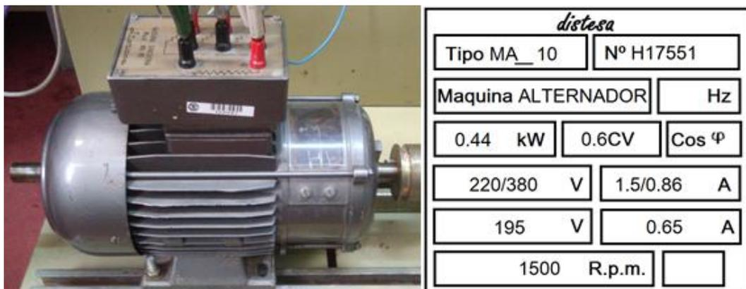
Figura 2: Máquina síncrona. Actúa como motor paso a paso o generador síncrono. A su derecha se puede ver su tabla de características
