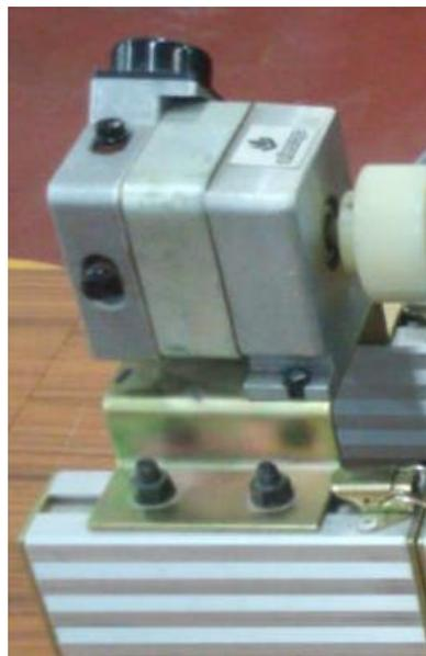
Figura 6: Tacómetro (30V x 1000rpm)
