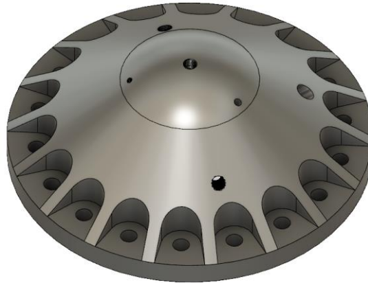
Figura 3.2. Tapa de la bomba en la instalación existente.
