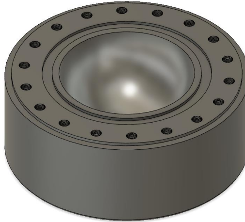
Figura 3.1. Base de la bomba en la instalación existente
