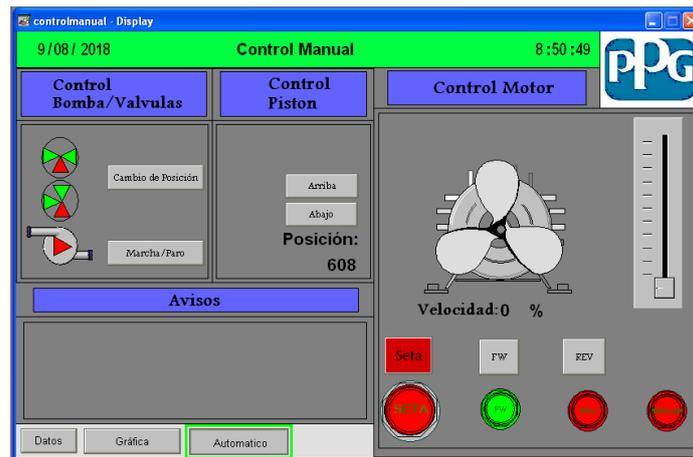
Ilustración 61 Programa de control manual en funcionamiento
