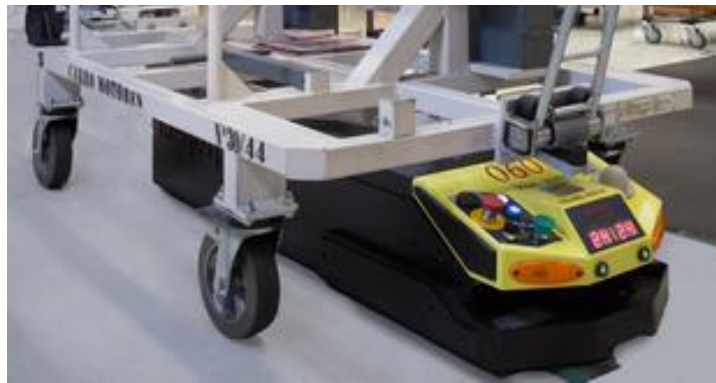
Figura 2. 23 AGV en funcionamiento [Foto interior Renault]
