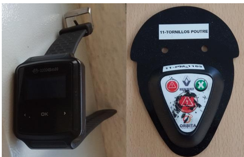
Figura 5. 8 Reloj y pulsador “Llamada operario” [Foto interior Renault]
