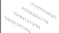
Las luces de las diferentes bandas de usos se cubren con vigas de acero aligeradas tipo Void, que aporta el aspecto industrial al proyecto.
