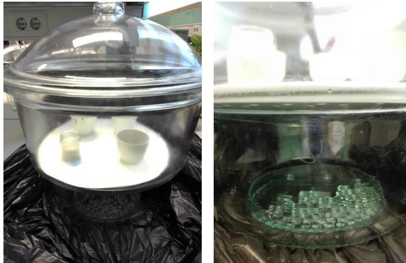
Figura 19 fumigación del suelo con cloroformo en bomba de vacío.
