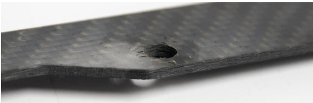
**Figura 1.1:** Muestra de un agujero con signos de daño por delaminación.
