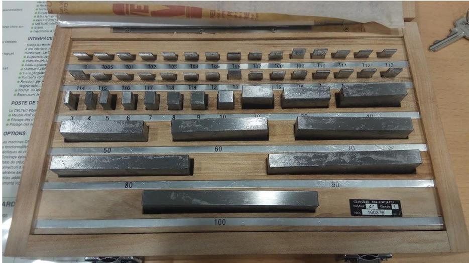
**Figura 3.7.** Bloques patrón empleados en el trabajo.
