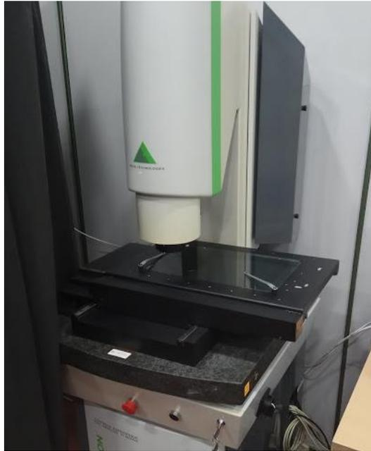
**Figura 3.1** Sistema de medición tridimensional DELTEC.
