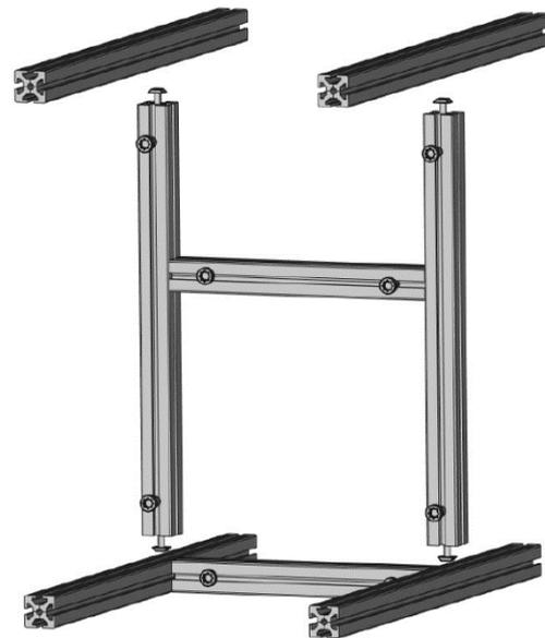
Figura 2.7.4. Cuarta instrucción de montaje del bastidor.
