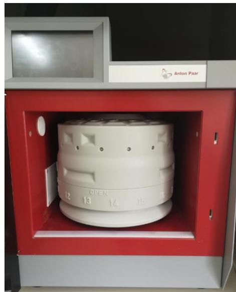
Figura 4.9- Equipo microondas con el rotor introducido en su interior.
