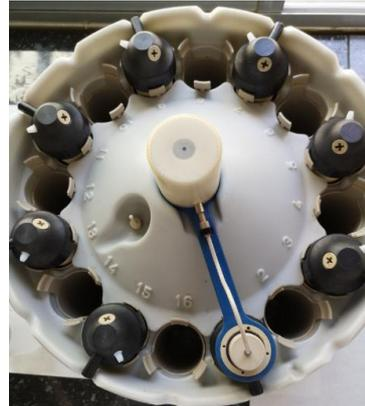
Figura 4.7- Rotor donde se colocan los tubos de presión.
