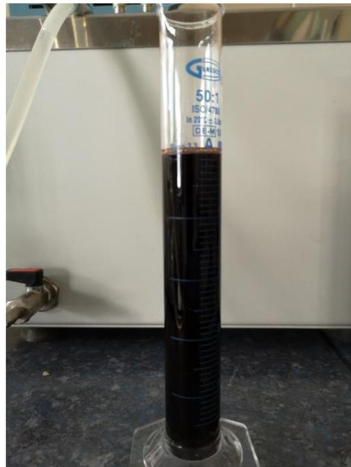
Figura 4.13- Extracto líquido rico en arabinoxilanos recuperado tras la centrifugación.
