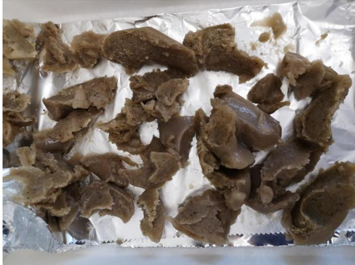
Figura 4.12- Sólido residual tras la centrifugación.
