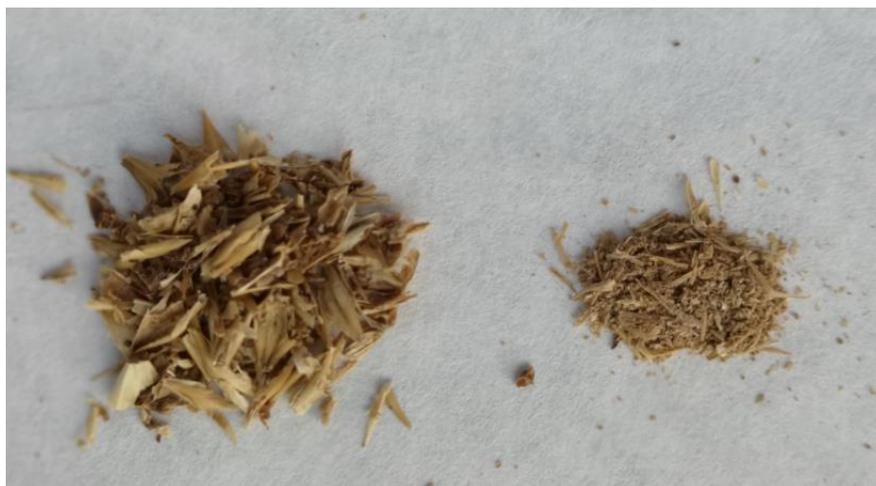
Figura 4.5- Diferencia de tamaño entre BSG antes y después de la molienda.
