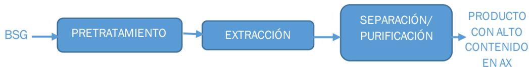
Figura 2.5 - Diagrama de bloques de las principales etapas en la obtención de AX a partir de BSG.
