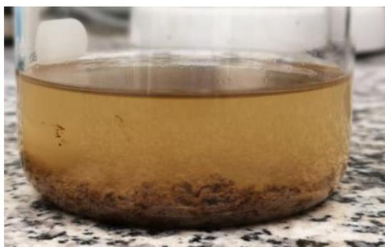
Figura 4.15- Resuspensión de AX en etanol 95%.
