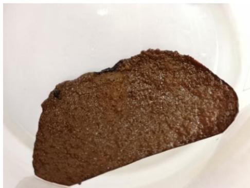
Figura 4.14- Fracción sólida centrifugada rica en AX.
