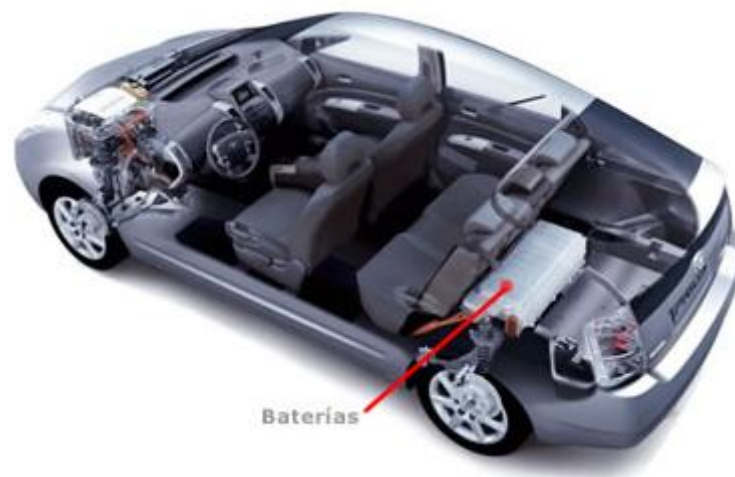
Ilustración 34: Baterías en Toyota Prius
