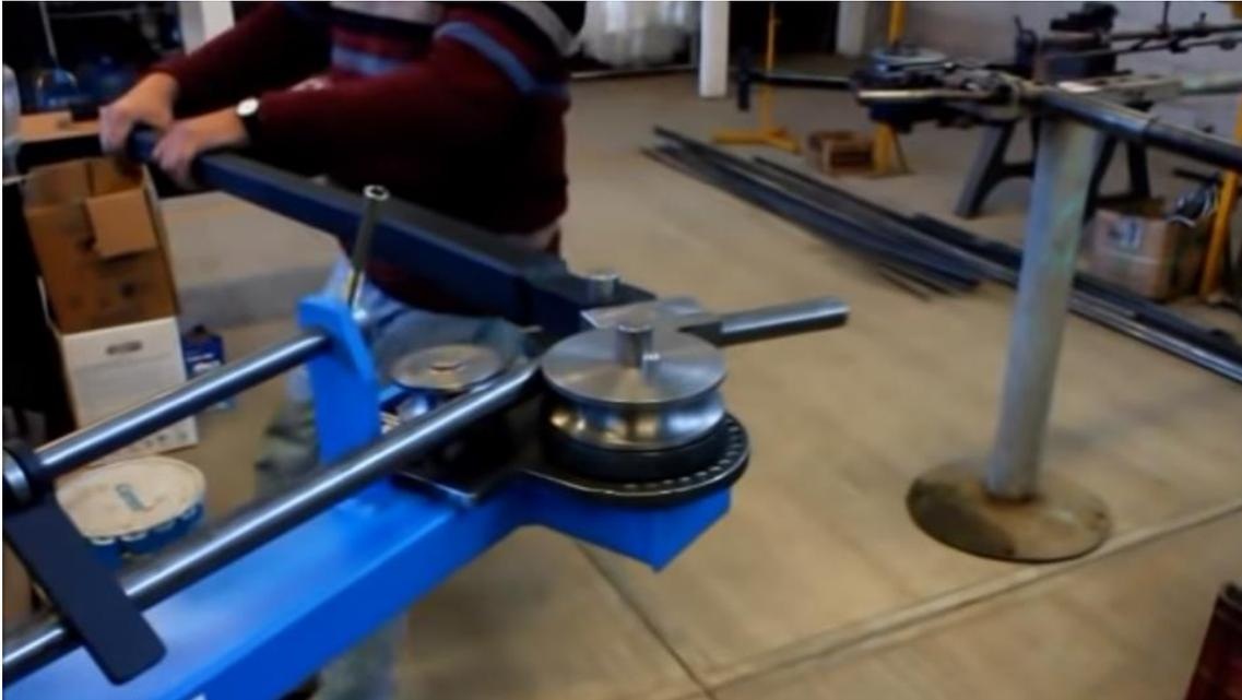
Tras llegar al ángulo buscado, se retira el anclaje de la barra y se comprueba si el resultado obtenido es el deseado.
