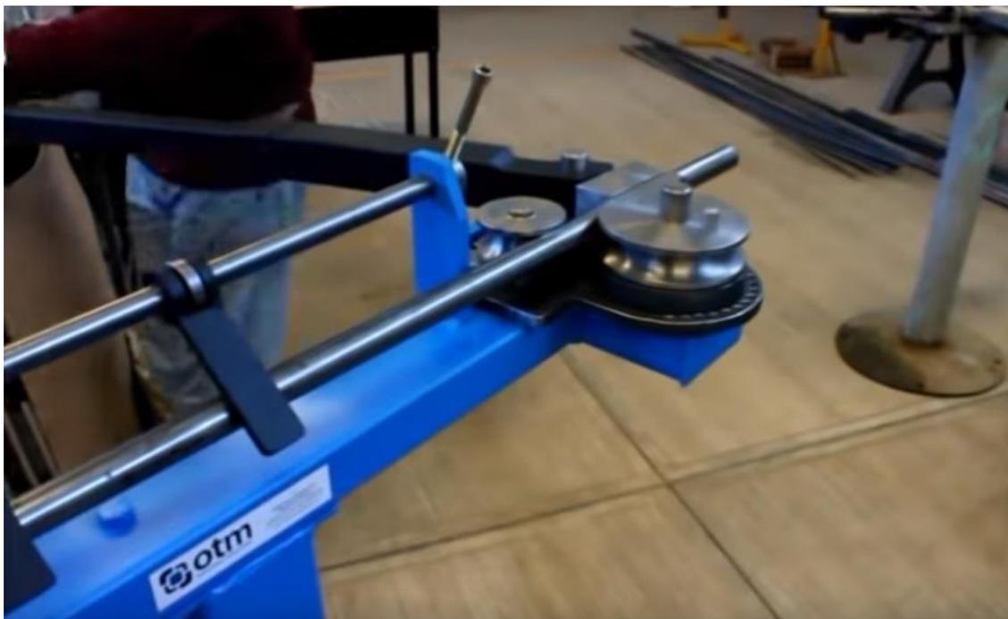
Después el operario, mediante el empleo de una palanca, hace la fuerza suficiente para doblar el tubo en la dirección deseada. Este es el caso de una plegadora manual, una industrial como la mostrada anteriormente lo hace de manera automática y con una mayor precisión. Ambas máquinas utilizan una palanca, solo que en una la fuerza la ejerce un operario y en la otra un motor.
