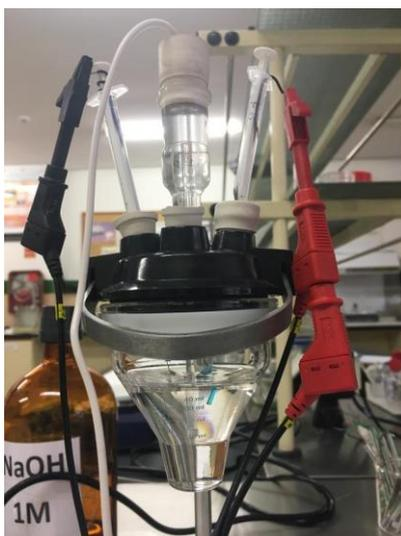
**Figura 38.** Celda electroquímica de tres electrodos.
