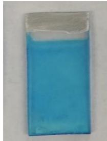
**Figura 31.** Sensor nanoestructurado en sustrato ITO preparado con la técnica Layer by Layer.
