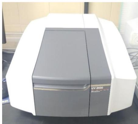
**Figura 35.** Espectrofotómetro UV-Vis modelo UV-2600.
