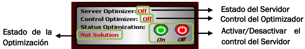
Figura 60. Panel de control y estado del servidor de la optimización
