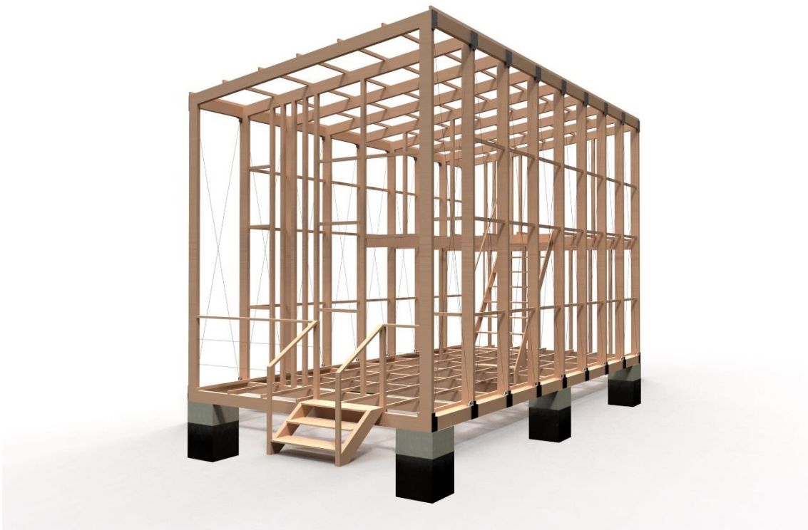
Fig. 45 Render estructura Néo Oikos Fuente: elaboración propia
