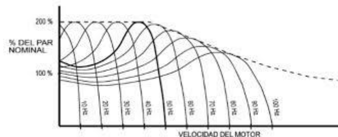
Gráfica 9.2: curvas de par-velocidad variando la frecuencia y el voltaje de entrada al motor
