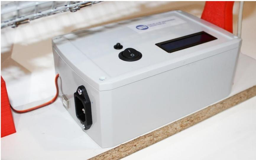
*Figura 3. Caja en detalle donde se aprecia la conexión de alimentación y de USB al PC*
