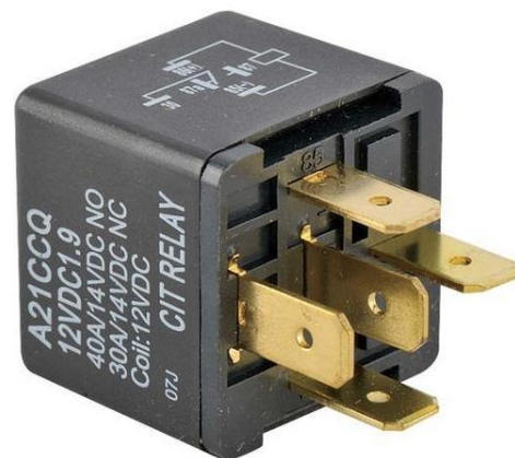
Figura 31:Relé usado para inmovilización (x2)
