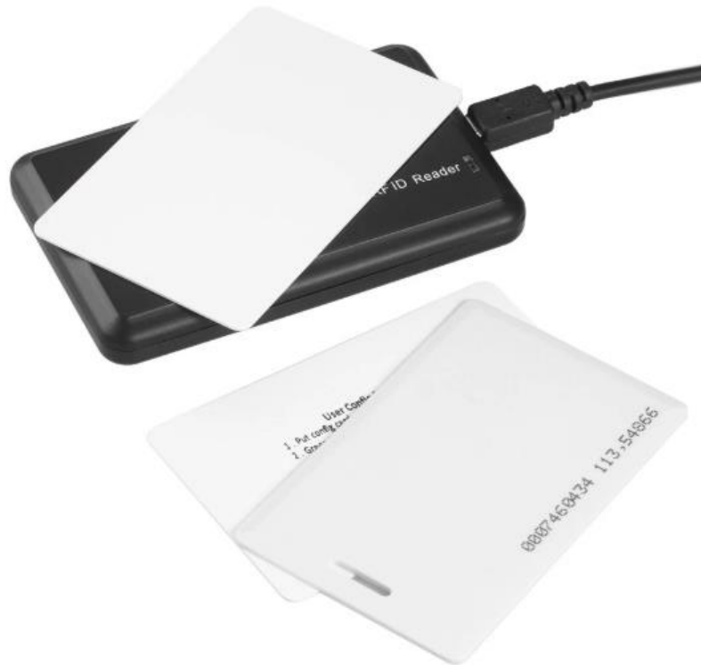
Figura 36: Lector RFID con tarjetas identificadoras
