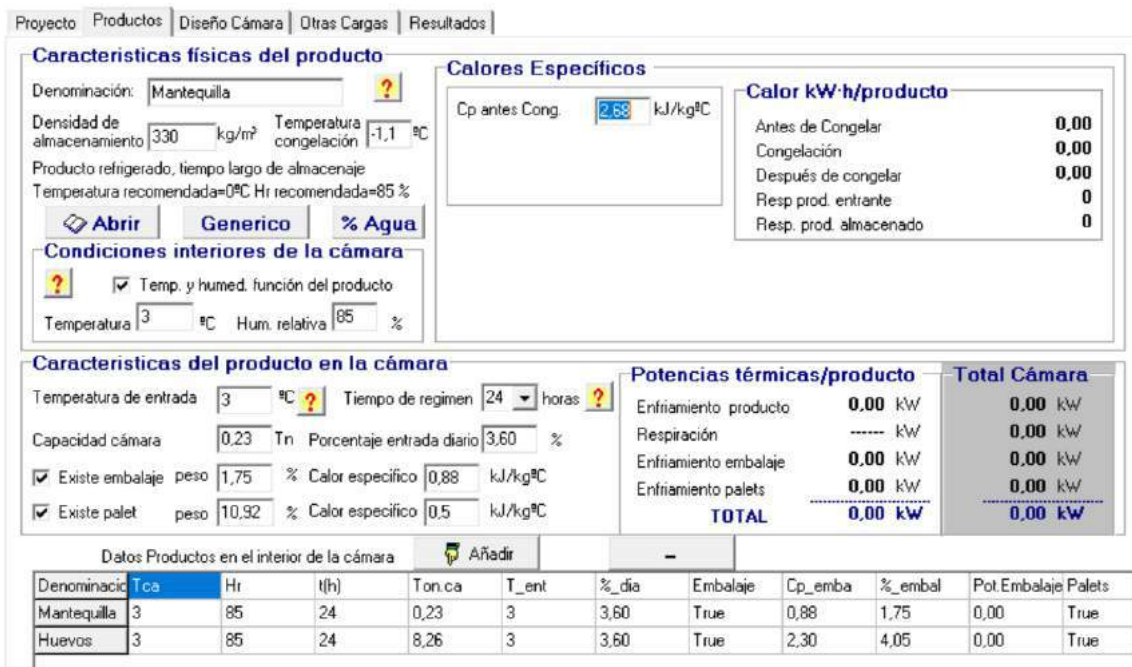
Figura 1. Cargas térmicas debidas a los productos en el almacén de materias primas refrigeradas
