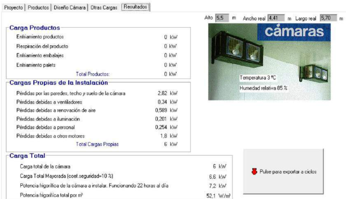
Figura 4. Necesidades frigoríficas totales para el almacén de materias primas refrigeradas
