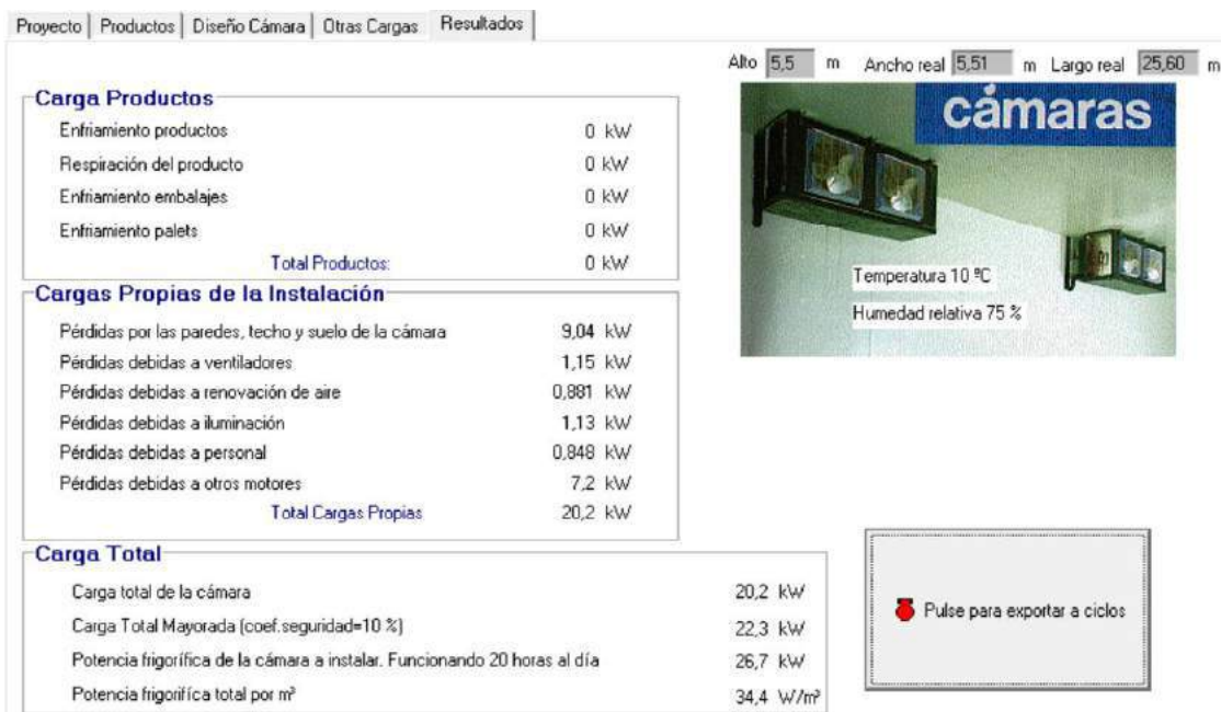
Figura 31. Necesidades frigoríficas totales para el pasillo de expedición de producto final
